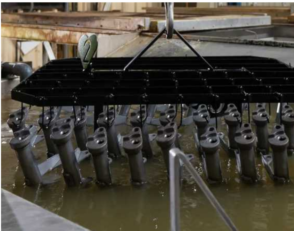
Üreges és bonyolult formák, illetve kisméretű, nagy darabszámú munkadarabok felületkezelése
